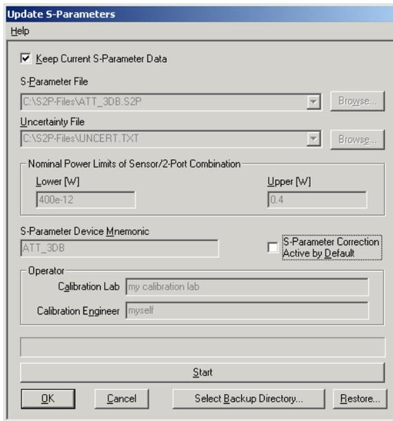
Bild 3-5 Nachträgliches Ändern des Reset-Zustandes der S-Parameter-Korrektur
