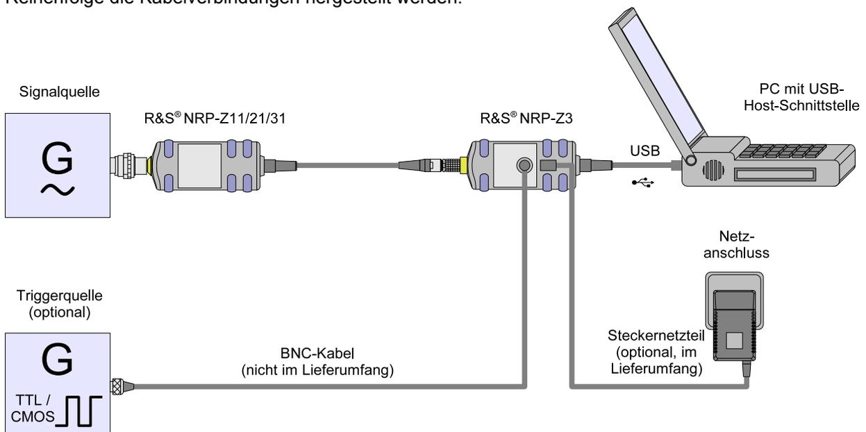
Bild 1-3 Konfiguration mit dem aktiven USB-Adapter R&S NRP-Z3
