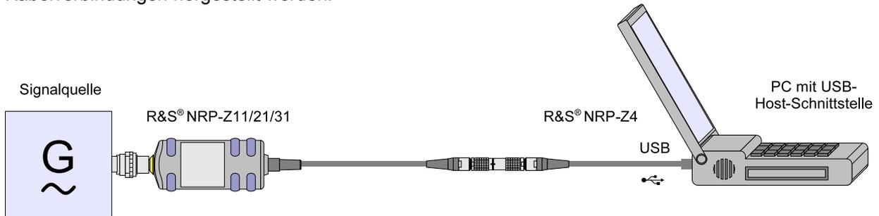
Bild 1-2 Konfiguration mit dem passiven USB-Adapter R&S NRP-Z4
