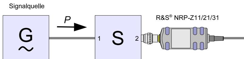
Bild 3-1 Betrieb mit Zweitort zwischen Signalquelle und Messkopfeingang
