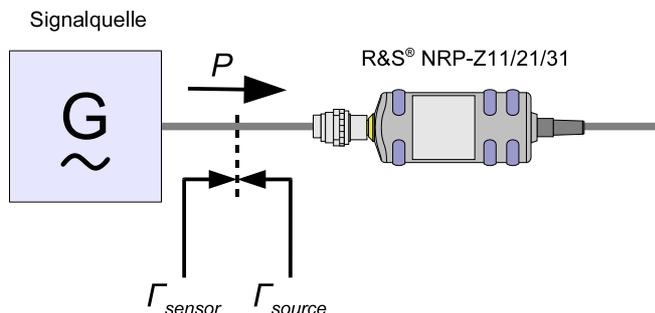
Bild 6-2 Korrektur der Wechselwirkungen zwischen Leistungsmesskopf und Signalquelle
