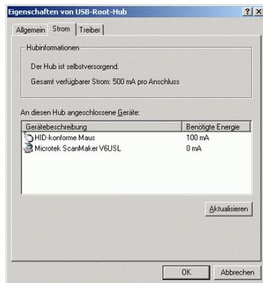
Bild 1-1 Gesamt verfügbaren Strom eines USB-Anschlusses anzeigen
