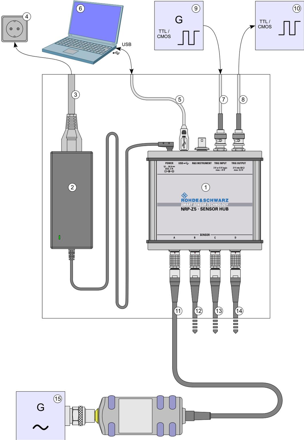
Bild 1-7 Typischer Messaufbau mit R&S NRP-Z5 und PC
